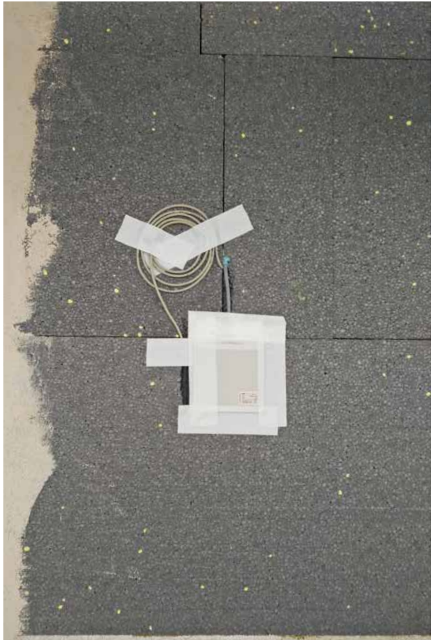
Abbildung 20 Wärmestrommessplatten außen (Fotoquelle: © Lehrstuhl ENPB, TU München)
