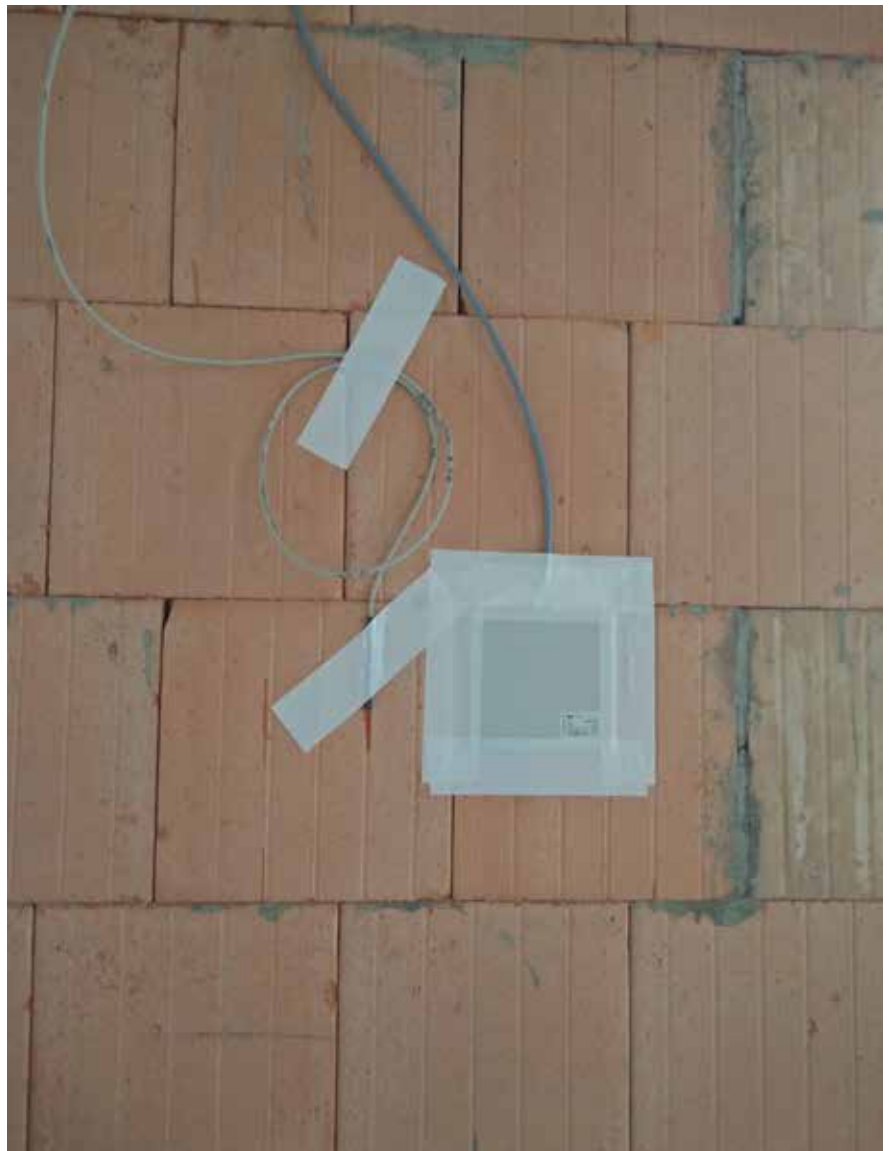
Abbildung 19 Wärmestrommessplatten innen (Fotoquelle: © Lehrstuhl ENPB, TU München)
